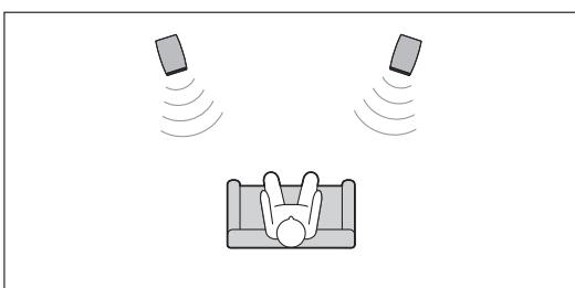
Einen besseren Stereoklang erreichen Sie, indem Sie die Lautsprecher leicht angewinkelt zum Hörer aufstellen.
