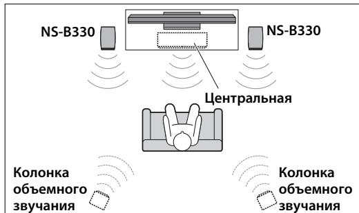
Установите колонки с обеих сторон телевизора. Общее качество звучания мультиканальной системы сильно зависит от пространственного расположения колонок. Настройте колонки в соответствии с положением слушателя, следя инструкциям, приведенным в руководстве по использованию усилителя.
