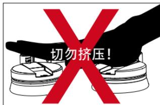
挤压耳机会增加耳机压力，可能破坏驱动器。
