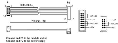
Der 911 wird mit dem erforderlichen Stromkabel für den Anschluss an ein Standard-Eurorack-Stromversorgungssystem geliefert. Befolgen Sie diese Schritte, um das Modul mit Strom zu versorgen. Es ist einfacher, diese Verbindungen herzustellen, bevor das Modul in ein Rackgehäuse eingebaut wurde.
