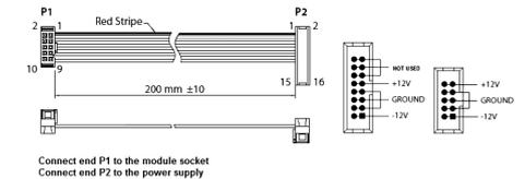
911 jest dostarczany z wymaganym kablem zasilającym do podłączenia do standardowego systemu zasilania Eurorack. Wykonaj poniższe czynności, aby podłączyć zasilanie do modułu. Łatwiej jest wykonać te połączenia przed zamontowaniem modułu w obudowie rack.
