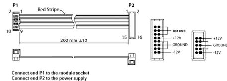
CP3A-M MIXER levereras med den nödvändiga strömkabeln för anslutning till ett vanligt Eurorack-nättaggregat. Följ dessa steg för att ansluta ström till modulen. Det är lättare att göra dessa anslutningar innan modulen har monterats i ett rackfodral.
