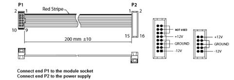
O 911 vem com o cabo de alimentação necessário para conexão a um sistema de fonte de alimentação Eurorack padrão. Siga estas etapas para conectar a alimentação ao módulo. É mais fácil fazer essas conexões antes que o módulo seja montado em um gabinete de rack.
