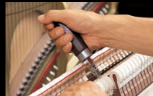
Voicing by skilled craftsmen Accordage par des techniciens expérimentés
